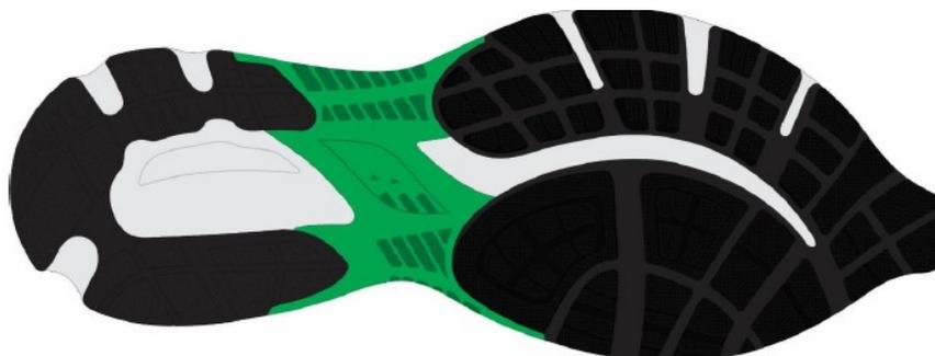
**SOLETA** - Confeccionada em policloreto de vinila dureza máxima 75, resistência ao desgaste máximo de 280 mm<sup>3</sup>, nas cores preta conforme desenho. Unida a entressola pelo processo denominado colado. Deverá conter sulcos para escoação de água e sujeiras, e assim melhor aderência.
